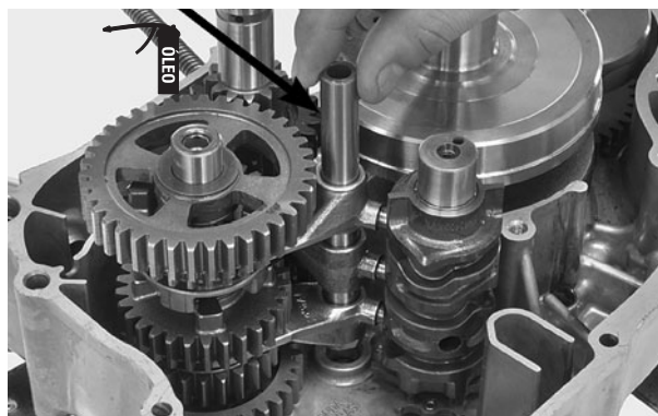
PINOS GUIAS EIXO DOS GARFOS SELETORES
